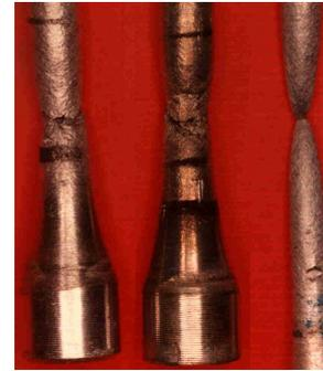
**Rupture ductile** : elle provient de l'allongement du matériau.
