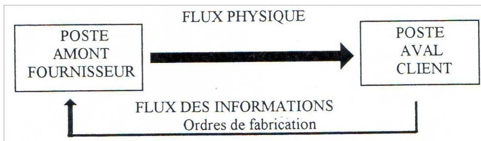
Le JUSTE A TEMPS revient à fabriquer à un instant donné ce qui est demandé. Elle se traduit par une production a flux tiré ou à flux tendu.
