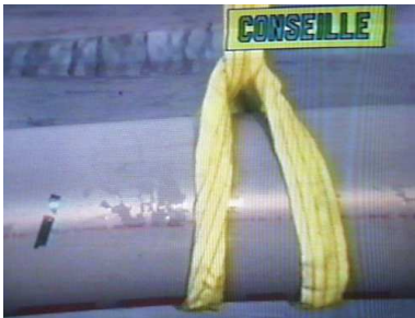
Nœud coulant 1 estrope et 1 brin (petites charges)
