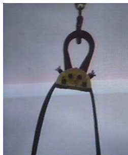
Elingue ajustable qui se règle en fonction du centre de gravité permet l'équilibrage de la charge
