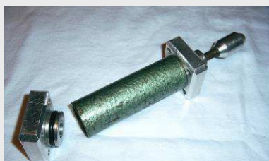
Démontage du fond arrière :
