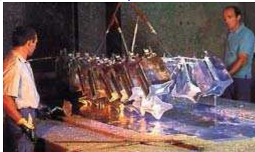
Fig. 3 - Tôlerie pour le bâtiment. Galvanisation à chaud (protection 25 ans, anti-feu accru, résistance abrasion).
