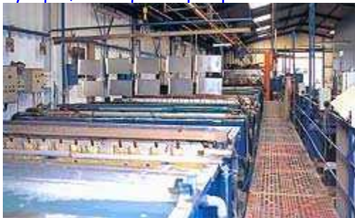
Fig. 3 - Tôlerie pour le bâtiment. Galvanisation à chaud (protection 25 ans, anti-feu accru, résistance abrasion).
