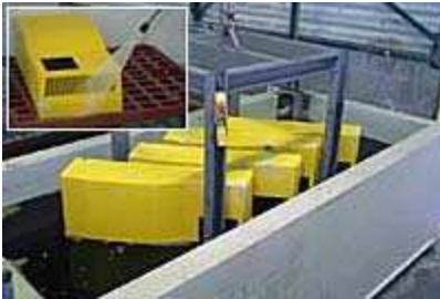
Fig. 5 - Les différents procédés de décapage chimique permettent d'éliminer tout type de revêtement (peinture, cata., etc...) pour le reconditionnement ou la remise en peinture de pièces dites "Sensibles" du type tôlerie fine, pièces en acier électrozingué, pièces en aluminium, etc...
